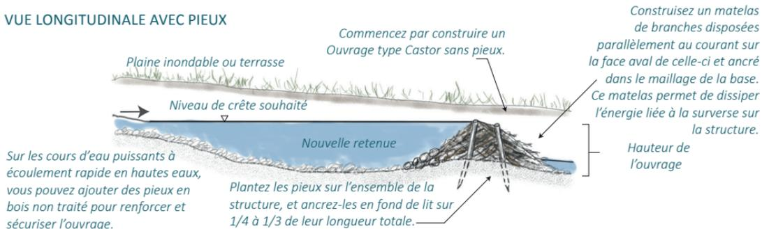
Sur les cours d'eau puissants à écoulement rapide en hautes eaux, vous pouvez ajouter des pieux en bois non traité pour renforcer et sécuriser l'ouvrage.
